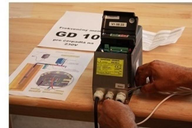
**3. Jednotlivé vodiče zapojíme podľa schémy v priloženom záručnom liste**
