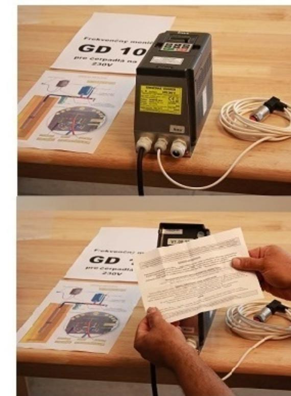
**2. Motorový kábel prestrčíme do otvoru na nerezovom kryte označenom "Motor"**
